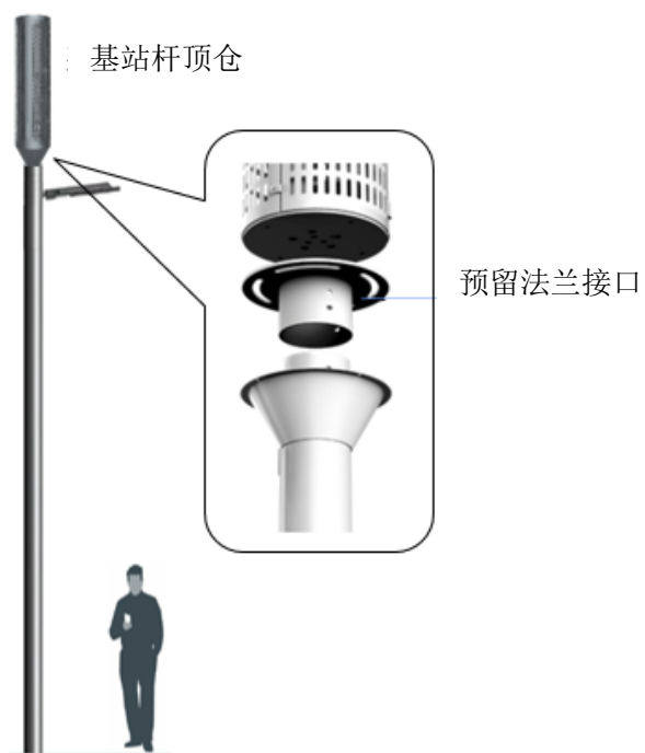
图 E.2 基站杆顶仓示例图
